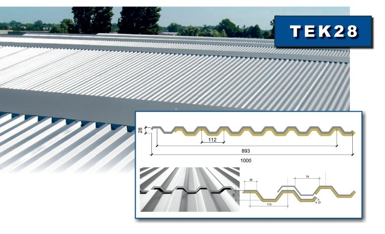
Das **TEK28** ist ein Trapezblechprofil mit einer 10mm starken PU-Schaumisolierschicht, um die Kondenswasserbildung zu vermeiden und das Geräusch- und Lärmverhalten bei Regen und Wind zu minimieren. Das verzinkt-beschichtete Stahlblech mit 0,6 mm weist durch seine 8 Hochsicken in der Höhe von 28 mm eine sehr hohe Festigkeit auf und verfügt somit über eine weite Spannweite bei der Montage. Die Befestigung ist sichtbar und erfolgt mit Kalotten inkl. EPDM-Dichtung.
