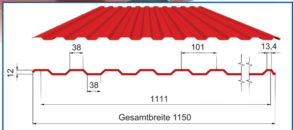
Das **Trapezblech T12 / 101** wird als Fassadenblech und vor allem als Untersichtblech verwendet. Es ist zur Verkleidung verschiedener Innen- und Außenwände geeignet. Das Trapezblech verfügt über eine fertige **Nutzbreite von 1111 mm** und hat eine Grundbreite von 1150 mm. Die nur 12 mm hohe, gleichmäßige Profilierung ergibt eine sehr schöne und angenehm empfundene Optik in Hinblick auf Wandverkleidungen.
