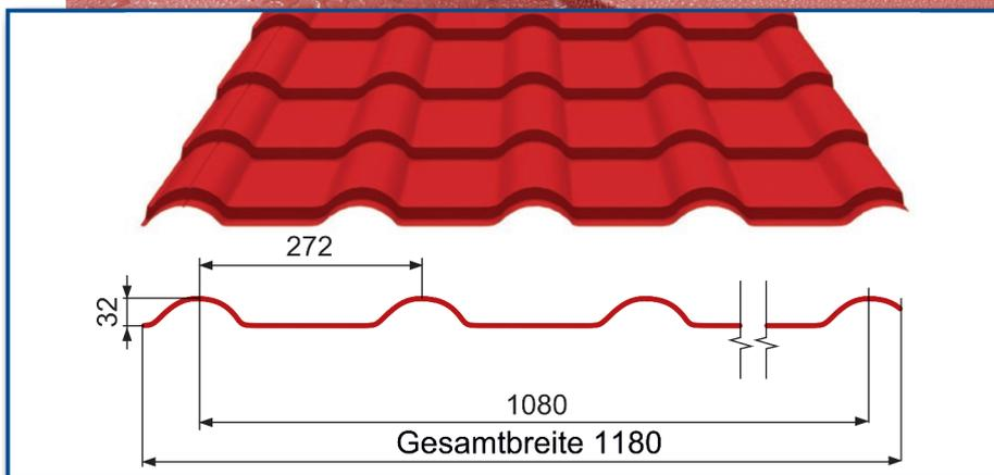
**GAPA** Profilblech ist eine Dacheindeckung mit symmetrischer Form, die an einen Betondachziegel erinnert. Die Profilierungshöhe von nur 32 mm verlangt eine Dachneigung von mindestens 12° mit Querverbindern oder zumindest 10° Dachneigung ohne Querverbinder.
