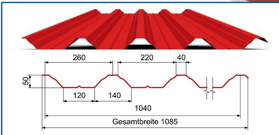
Das Trapezblech **T50 / 260** wird vorwiegend als tragendes Dachprofil für geringe Neigungen und höhere Spannweiten verwendet. Die Beständigkeit und Belastungsfähigkeit aufgrund der höheren Wellen ergibt eine ausreichende Festigkeit für den breiten Einsatzbereich im Bauwesen. Das Trapezblech hat eine Breite von 1085 mm und verfügt über eine fertige **Deckbreite von 1040 mm** nach einfacher Überlappung der 50 mm hohen Hochsickenprofilierung.
